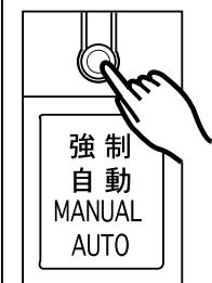
**Бутоn MANUAL AUTO** за ръчно включване в автоматичен режим на работа при повреда на дистанционното управление. Вътрешното тяло се включва на автоматичен режим (AUTO).
